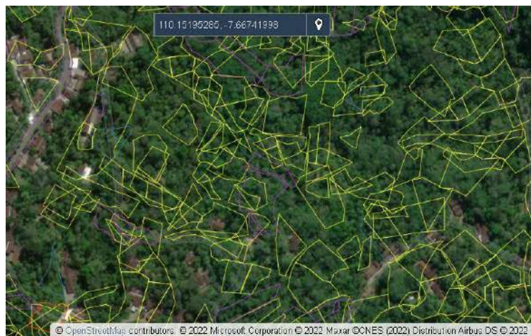
Gambar 2.1 Tampilan Bidang Tanah Tumpang Tindih Pada Peta Digital Kantor Pertanahan Kabupaten Kulon Progo
