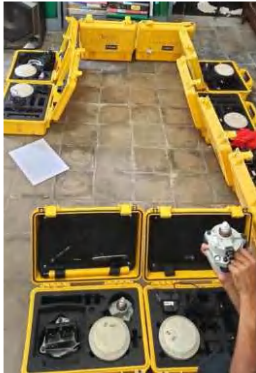
Gambar 3. 9. Pengecekan kelengkapan komponen alat ukur
