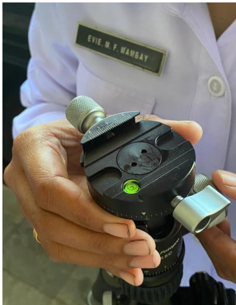
Gambar 3.14. Memposisikan nivo tabung ppada tripod
