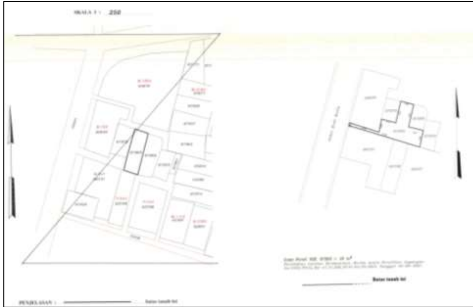
Gambar 20. Perubahan Bentuk dan Luas di Surat Ukur NIB 07969
