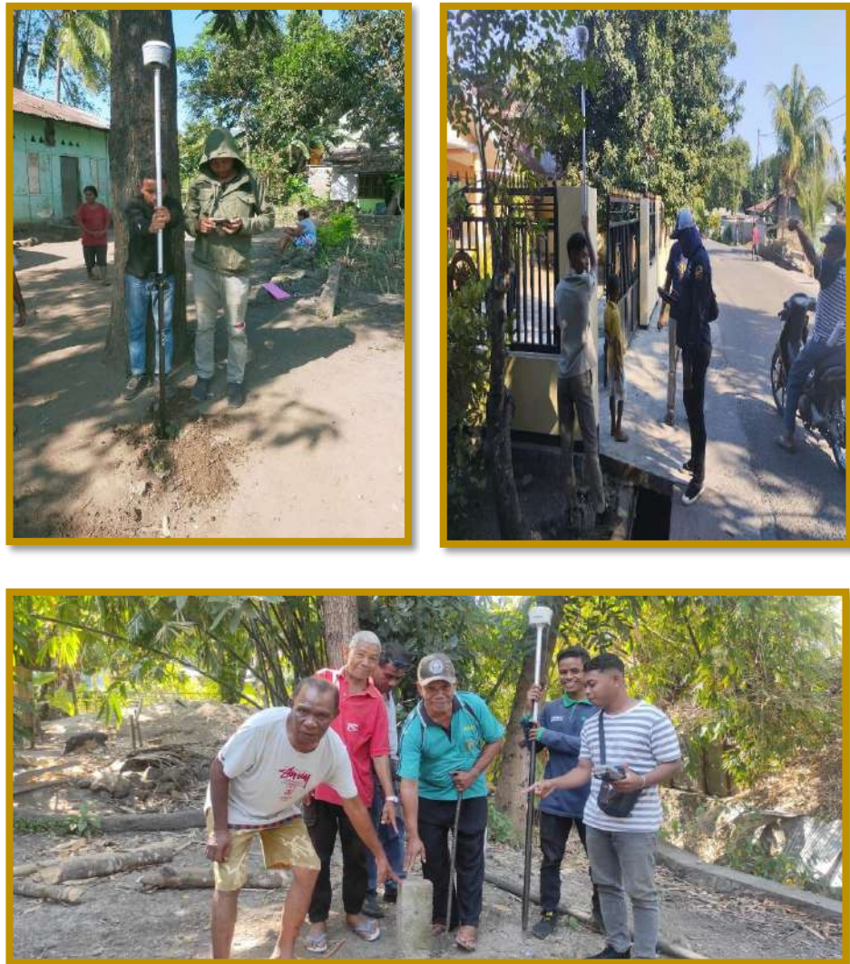
Gambar 3.4 Pengukuran Bidang Tanah Menggunakan GNSS Cors dan RTK
