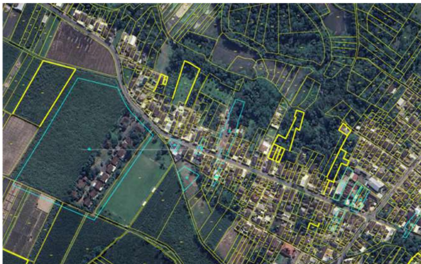
Keterangan Gambar : Hasil opname bidang tanah yang tidak berada pada posisi sebenarnya
